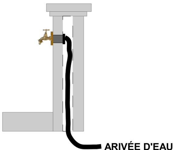
Raccordement du tuyau d'eau à l'intérieur d'une fontaine borne (vue de dessus)
