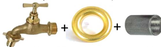
1 robinet en laiton poli filetage 2,5 cm, 1 collerette en laiton poli Ø intérieur 2,6 cm et Ø extérieur 7,7 cm et 1 manchon filetage 2,5 cm
